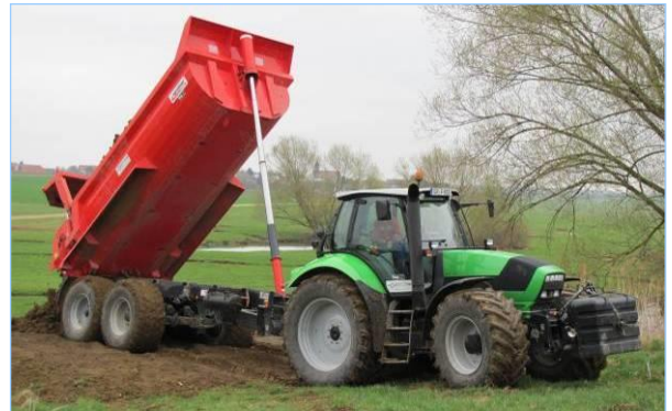
Abb. 2.7.18: Ballonbereifter Schlepper mit Halfpipe.
