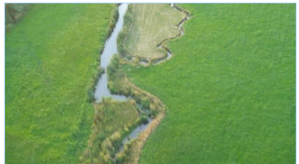
Abb. 2.2.23: Größenvergleich: oben: neu trassierter, renaturierter Bach mit vermindertem Gefälle und naturraumtypischem Querprofil. unten: Durch Vorlandabtragung entstandene Umgestaltung als Ausleitung mit hohem Gefälle und stark vergrößertem Querprofil. links: eingestautes ehemaliges Bachbett. (Foto Gerner)
