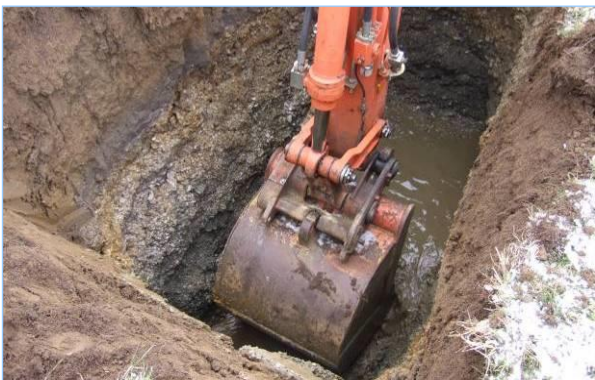
Abb. 2.7.21: Kiesabbau in der Egerau. Die Schicht ist 1 m überdeckt und 2 m mächtig. (Foto Strauß)
