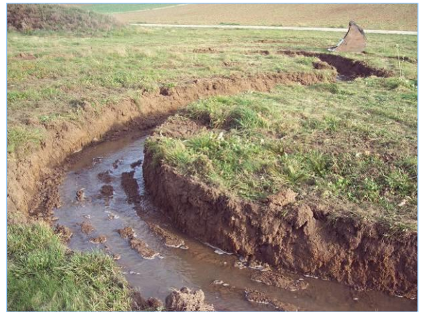
Abb. 2.2.8: Das Kastenprofil vor der Flutung. (Foto Elser)
