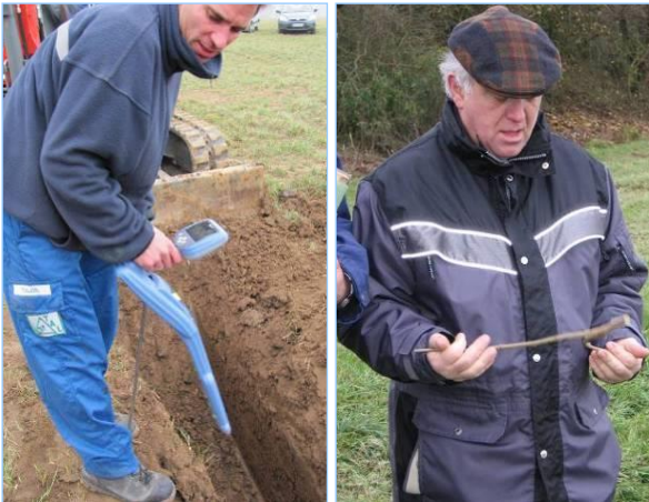
Abb. 3.1.1: links: Renaturierungsfeind Leitungsdschungel: An dieser Stelle tummeln sich die Abwasserleitung Itzlingen-Oberdorf, die transalpine Ölleitung, eine NATO-Ölpipeline, ein Lichtwellenleiter, die Ethylenpipeline Süd und benachbart ein Hochspannungserdkabel. Mit dem Gerät können zur Leitungsortung induzierte elektromagnetische Wechselfelder detektiert werden. (Sechta Bopfinger), rechts: Ein Flurneuerer bei der Drainagensuche. Die Trefferquote dieser traditionellen Suchmethode war vernachlässigbar. (Schlierbach)
