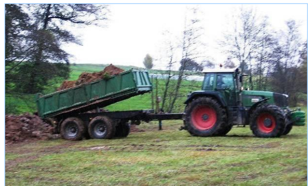
Abb. 2.6.11: Nach den Erfahrungen an der Ellenberger Rot kamen am Sixenbach erstmalig vollständig ballonbereifte Fahrzeuge zum Einsatz.
