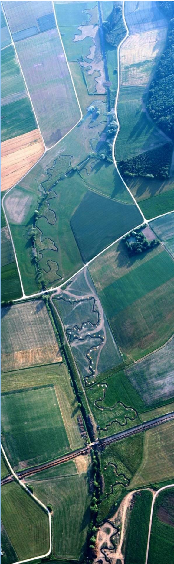
Abb. 2.7.4: Die renaturierte Sechta. Im unteren Teil führten Zwangspunkte und GPS-Mangel zu einigen eher kunstvollen Abschnitten. (Foto Vischer)
