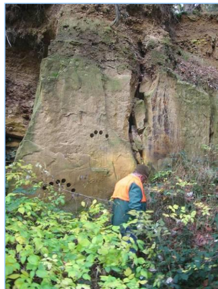
Abb. 2.1.17: Aus diesem alten Steinbruch sollte ursprünglich das Geschiebe für den Schelmenklingenbach kommen. Heute lässt die Ulmer Dom-bauhütte Bohrkern entnehmen (s. Löcher).
