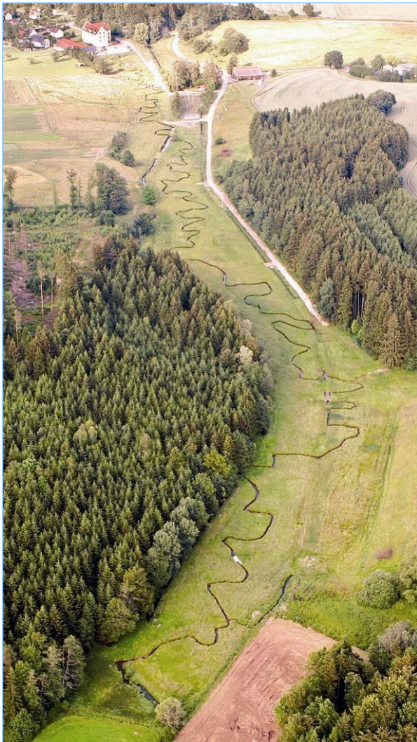
Abb. 2.6.1: Gesamtansicht des renaturierten Sixenbachs. Die Linienführung wurde vom Referenzgewässer abgeleitet (Abb. 2.4.6). Der alte Bachlauf liegt am linken Waldrand. (Foto Euroheli)
