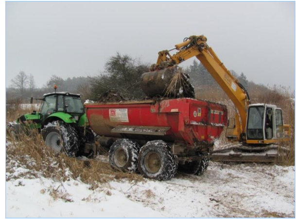
Abb. 1.2.12: Kettenbagger und ballonbereifte Schlepper erwiesen sich als die besten Baufahrzeuge. (Sechta Bopfingen)
