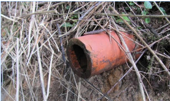
Typisches Drainrohr aus Ton, im Beispiel mit einem Außendurchmesser von 7 cm und einem Innendurchmesser von 5 cm. (Glasbach)
