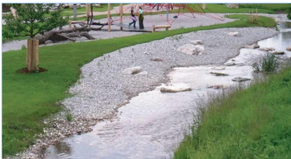
Abb. 1.1.9: Risikoarm gestalteter Bacherlebnisbereich. Durch ausschließliche Einbringung von gerundetem Kies und durch regelmäßig gemähte Rasenbereiche wird die Verletzungsgefahr im Barfußfall minimiert. (Foto Oberösterreichische Akademie für Umwelt und Natur)
