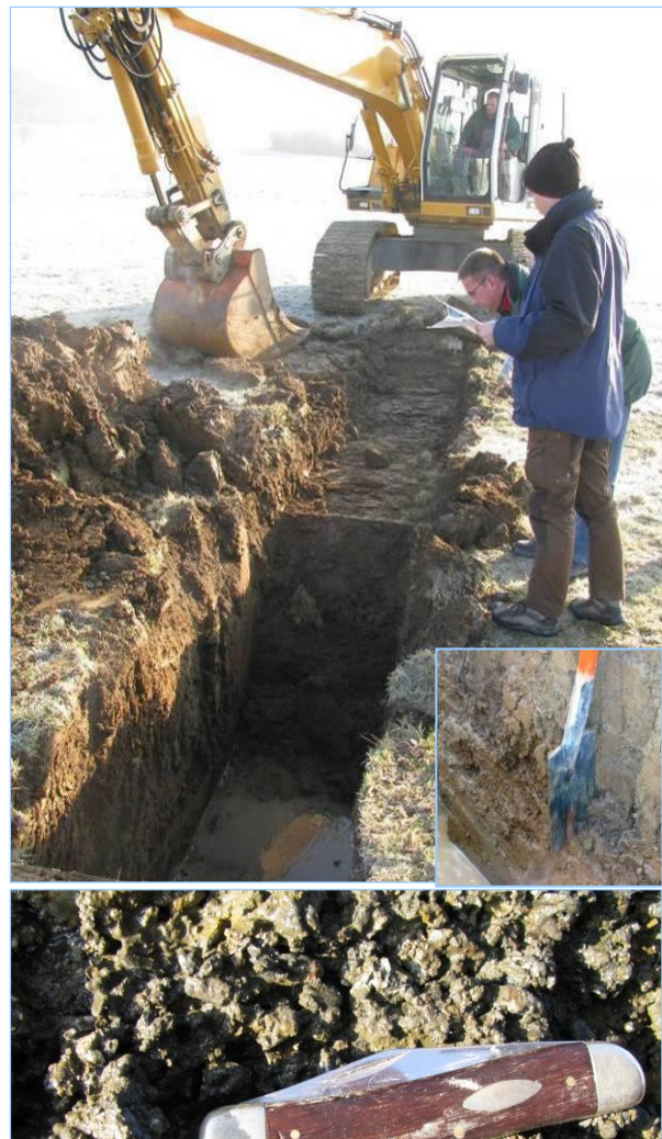
Abb. 2.7.10: Baggerschurf zur Bestimmung der Tiefe der ursprünglichen Sechta. Die ehemalige Bachsohle war an der wechselnden Färbung des Erdreichs zu erkennen (rechts). Die Breite ist im Gelände nicht mehr dokumentiert. Der periglaziale Bachkies (unten) findet sich erst in einer Tiefe von 2,5 Metern. (Fotos Elser)
